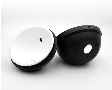
积分球反射测量装置示意图
